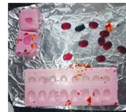
Produktionsformen für die zweifarbigen Leuchtengläser
