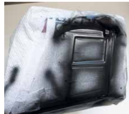
Die Fensterrahmen werden schwarz seidenmatt lackiert
