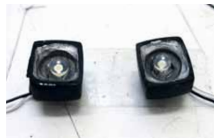
Gehäuse mit abgeflachter LED für die Seitenstrahler
