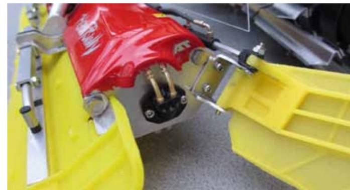
Hydraulikmotorgehäuse und Finisher-Befestigung
