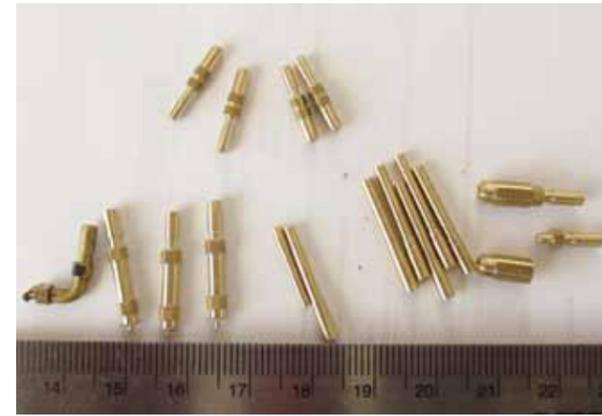
Um die kleinen Messingteile ohne Bruchgefahr biegen zu können, erhitzt man sie am besten mit einem kleinen Gas-Lötbrenner
